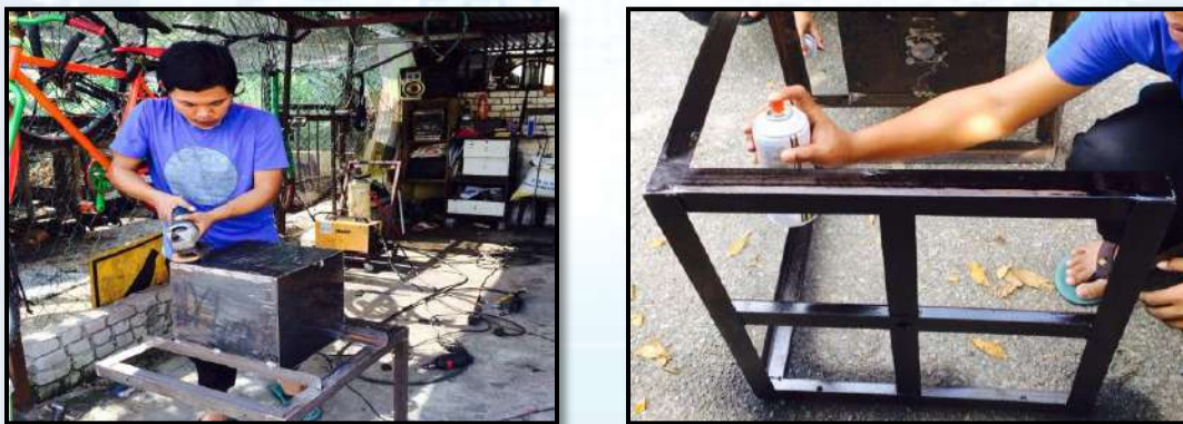
Rajah 4 : Proses mengecat dan pemasangan kerangka
