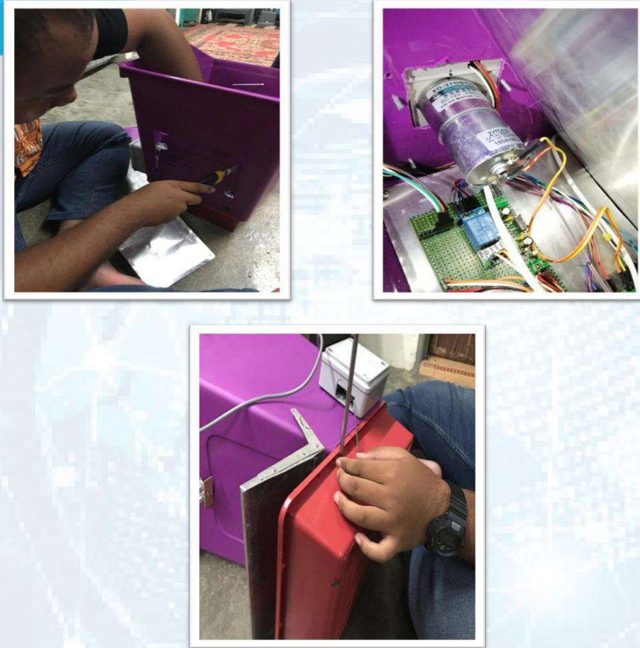
Rajah 4: Mencantumkan komponen elektronik pada bekas plastik
