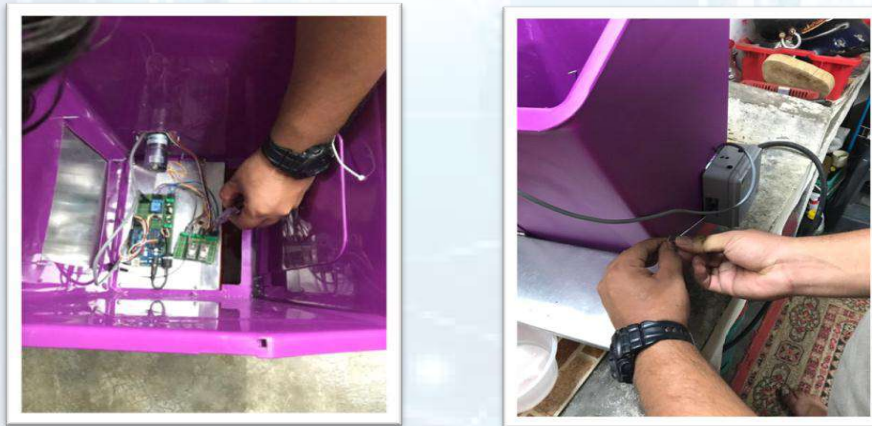
Rajah 2: Pemasangan Arduino Uno dan sensor ultrasonik
