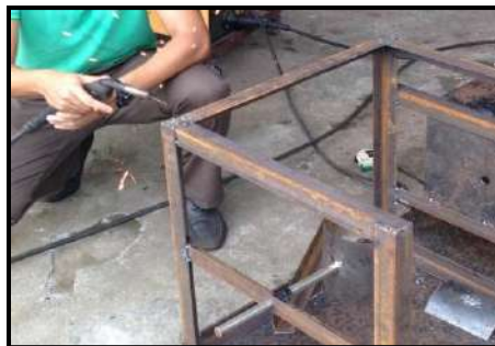
Rajah 2 : Proses kimpalan bagi penyambungan penghadang dan tapak kerja.
