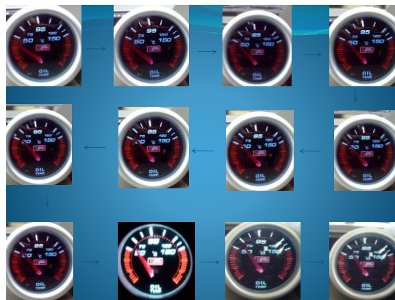
Rajah 10: Bacaan Meter Selepas Pemasangan Oil Cooler
