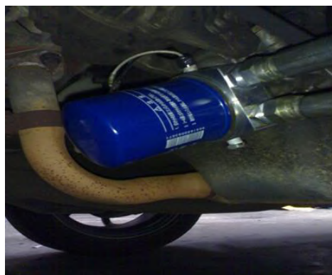
Rajah 4: Pemasangan oil filter, adapter, peranti, dan hos pada ruangan enjin
