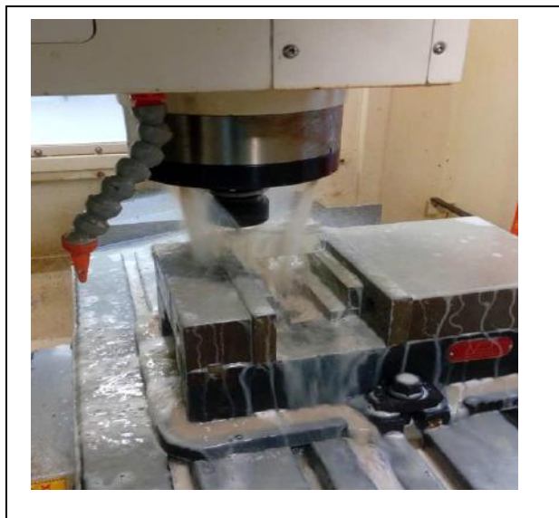
Rajah 3.3: Proses pembuatan ABM dengan menggunakan mesin CNC Milling.
