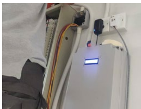
Proses menyambungkan Device Controller dengan DB
