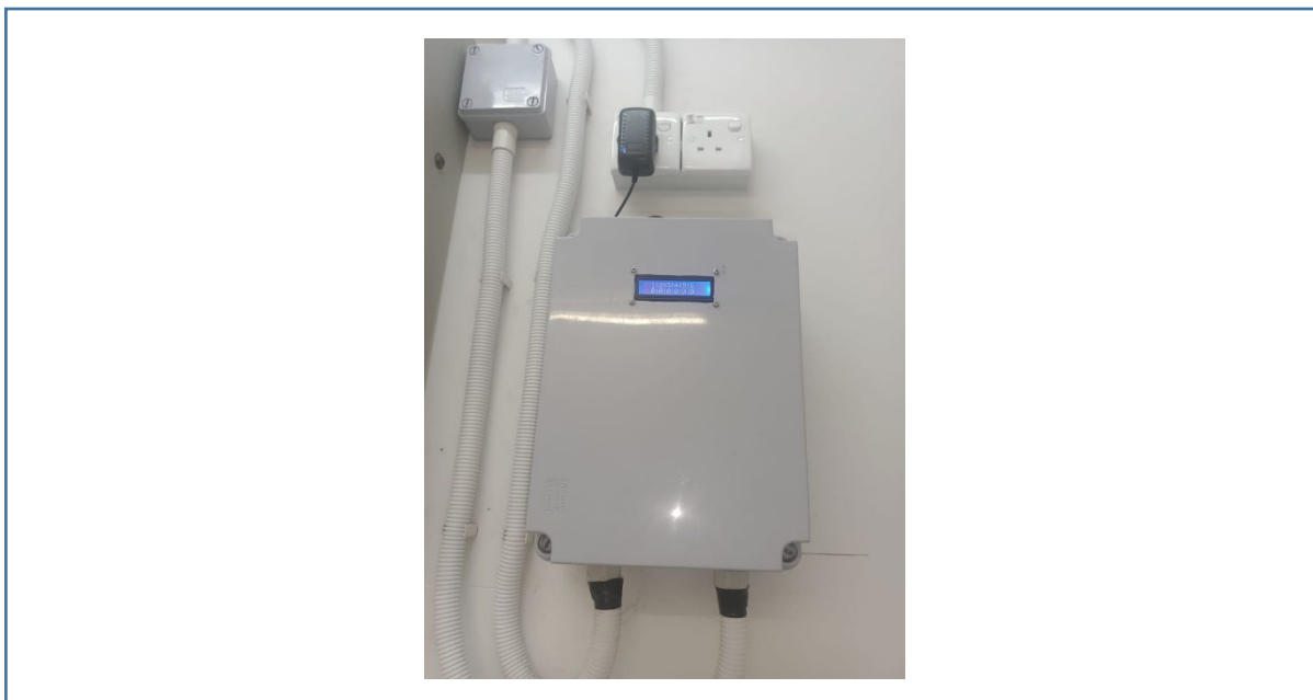
Rajah 15 Device Controller iReSS yang Telah Siap Disambung Dengan DB Suis BKT4
