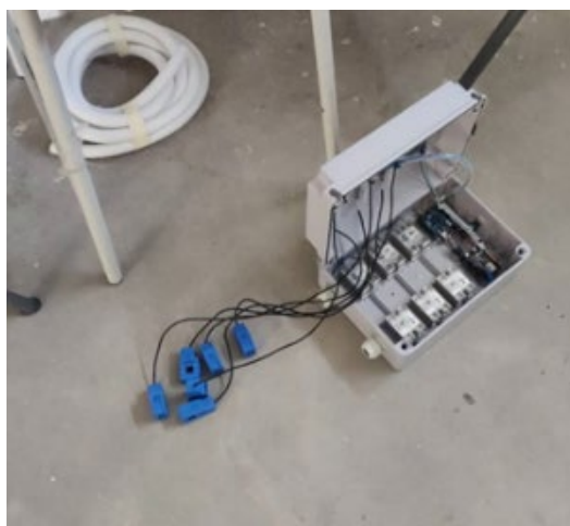
Menyediakan Device Controller untuk penyambungan dengan DB
