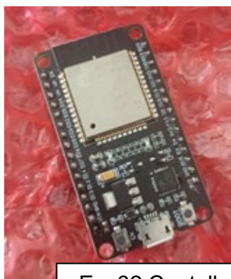
Esp32 Controller dan ESP32 Shield untuk penyambungan peralatan dengan internet, aplikasi dan kawalan suis jarak jauh
